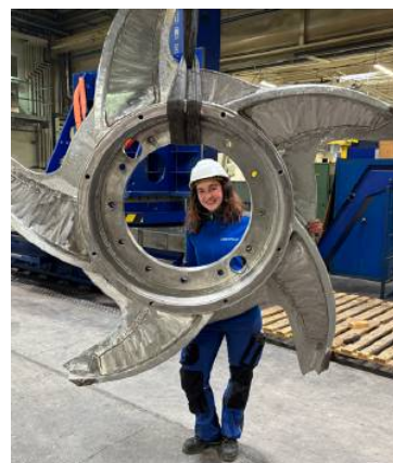
Das Spezialteil für einen Altpapierlöser wiegt 1,5 Tonnen.
